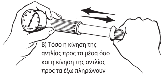
Εικόνα 3. Λειτουργία της αντλίας χειρός
